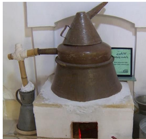
شکل ۱. گلاب گیری سنتی با تشت و نیچه
